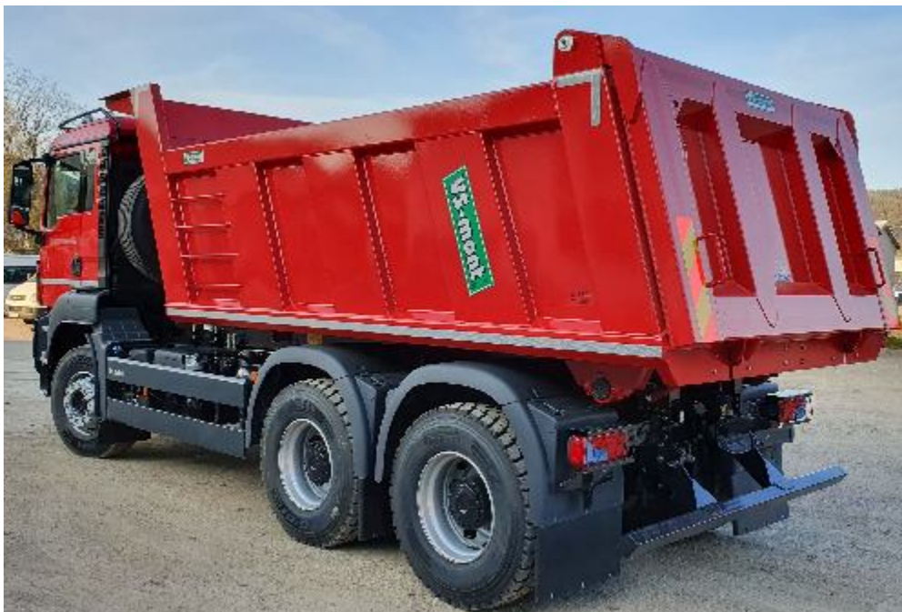
Jednostranná hranatá nadstavba určená pre 3-nápravové podvozky 6x4, 6x6
