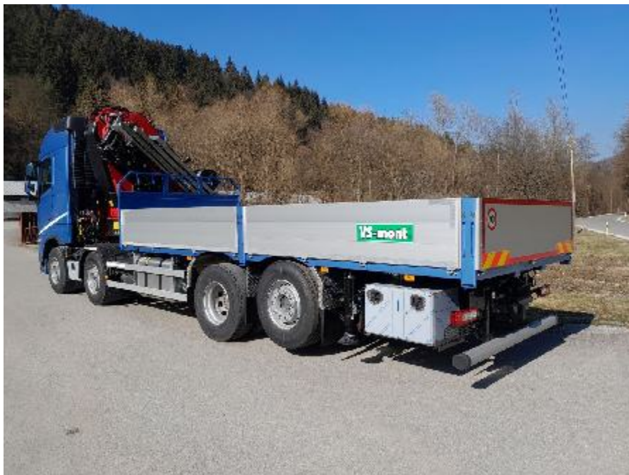
Valníková nadstavba určená pre 4-nápravové podvozky do 41t
