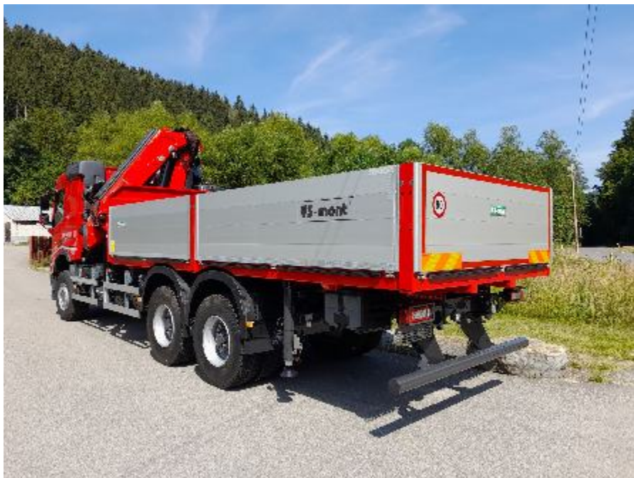
Valníková nadstavba určená pre 3-nápravové podvozky do 26t
