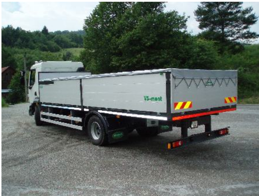
Valníková nadstavba určená pre 2-nápravové podvozky do 18t
