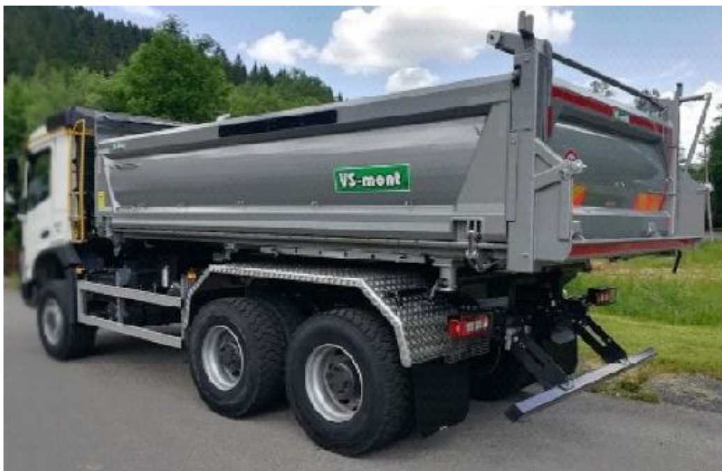
Trojstranná nadstavba S3 určená pre 3-nápravové podvozky 6x4, 6x6
