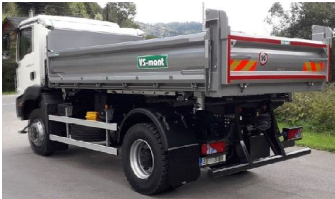
Trojstranná nadstavba S3 určená pre 2-nápravové podvozky 4x2, 4x4
