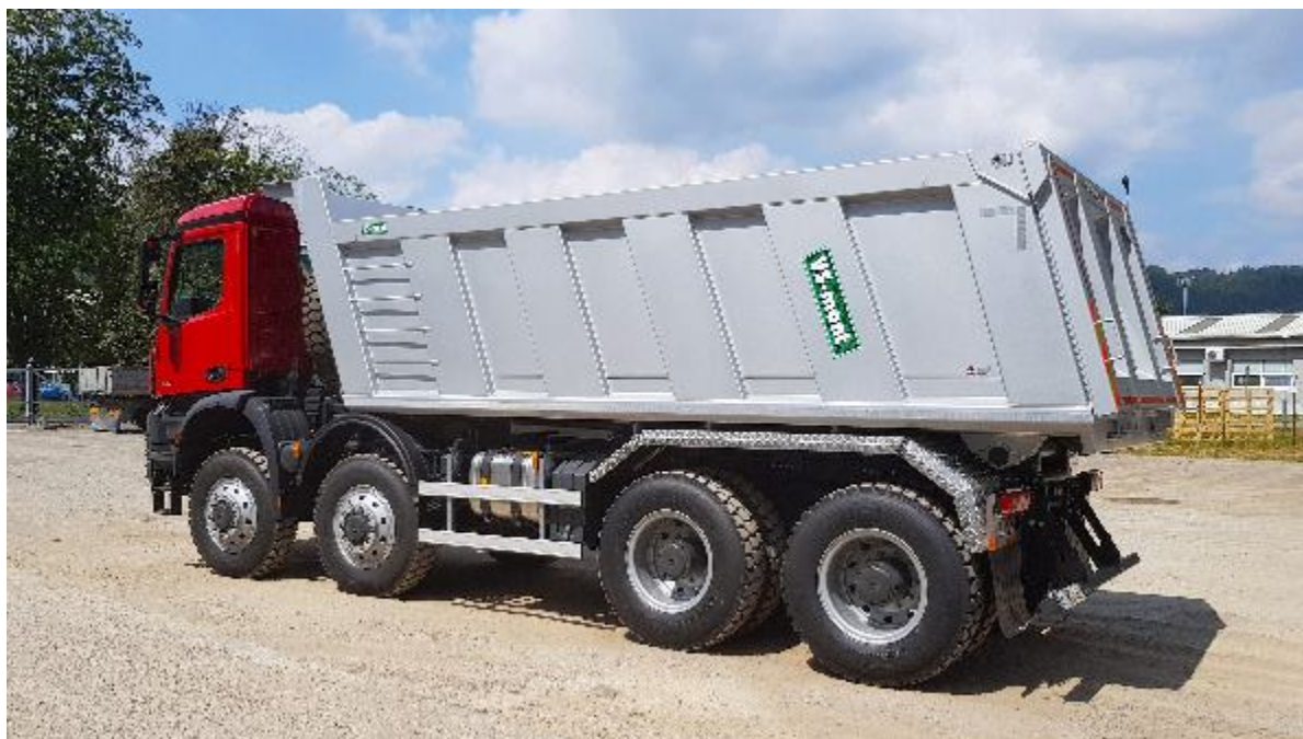
Jednostranná hranatá nadstavba určená pre 4-nápravové podvozky 8x4,8x6
