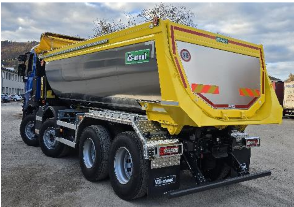
Tepelne izolovaná jednostranná polkruhovú nadstavba S1GT určená pre 4-N podvozky 8x4,8x6
