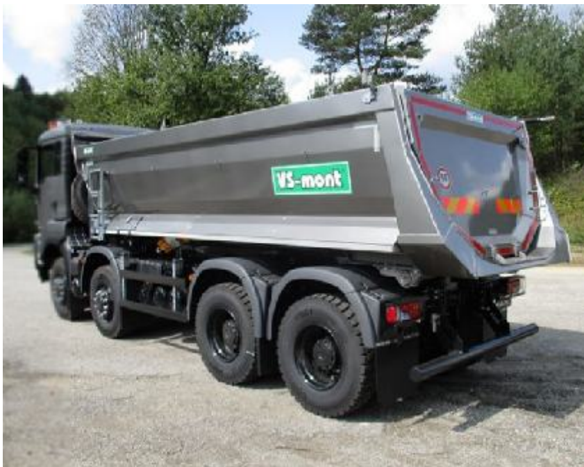
Jednostranná polkruhová kónusová nadstavba S1G určená pre 4-nápravové podvozky 8x4,8x6
